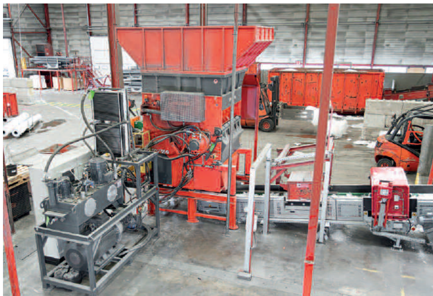
WEIMA W5.18 Einwellen-Zerkleinerer für LDPE-Folien bei RKW
